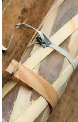
Die Eschlbeck-Kabelbinder waren sehr montagefreundlich, wiesen aber nach einem Winter bei ca. 20% der Bänder Brüche auf. Bei den neuen Bändern aus Baumwolle mit Metallclip gibt es keine Probleme mehr.
